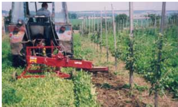
Okopávač s výchylnou sekcí při práci v sadu
